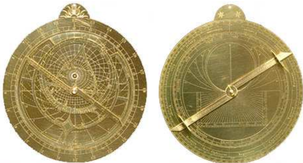
Araignée et tympan à gauche, dos à droite d'un astrolabe moderne (B. Alix)
